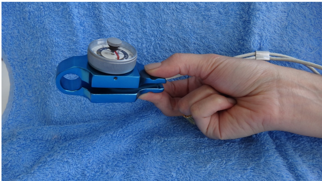
Figura 11- B&L Pinch-Gauge®: Avaliação da força de pinça três pontos
