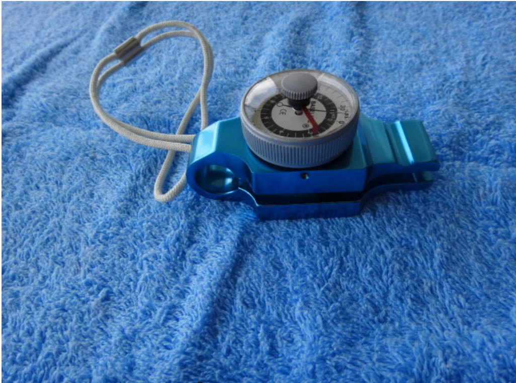
Figura 9- B&L Pinch-Gauge ® : Aparelho para medir a força das diferentes pinças – lateral, três pontos e polpa a polpa
