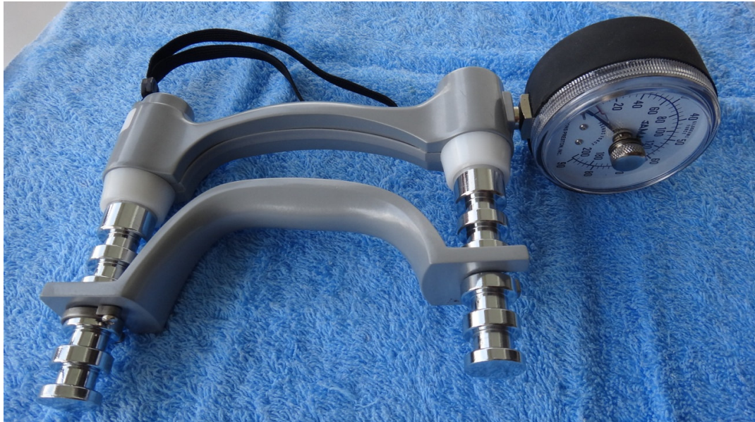
Figura 7- Dinamômetro Jamar ® : Aparelho para medir a força de preensão palmar
