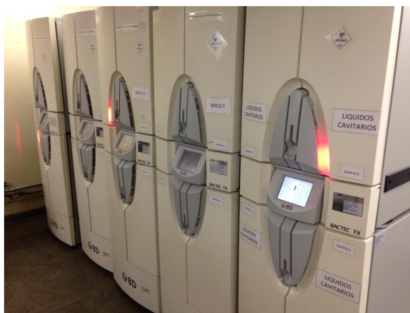
Figura 15 – Equipamento BD Bactec FX para processamento dos frascos de hemocultura contendo o líquido da sonicação
