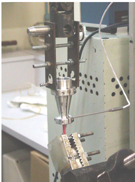
Figura 8 – Posicionamento com angulação de 135^{\circ} entre garra retangular inferior e a garra cônica superior com termômetro acoplado.
