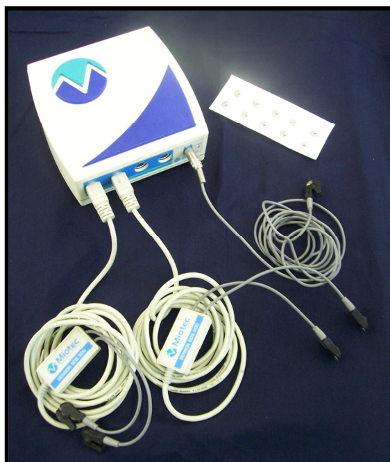
Figura 2. Eletromiógrafo de superfície marca Miotec, modelo Miotool 400, de 4 canais, com 14 bites de resolução de faixa dinâmica.
