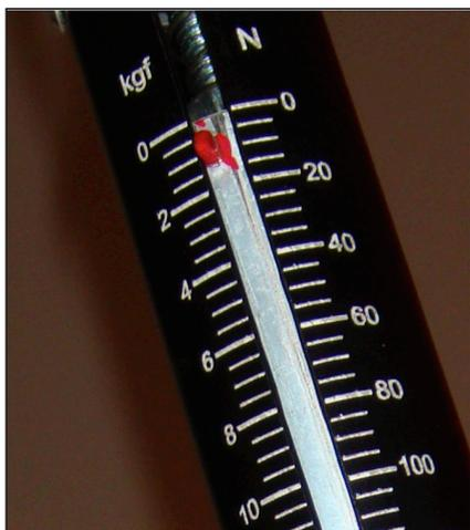
**Figura 19** - Destaque para a gradação do dinamômetro em quilograma-força e Newtons
