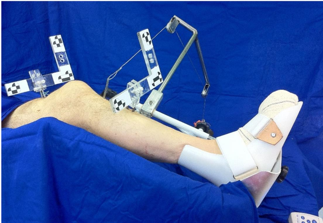
**Figura 15** - Aparelho de “pivot shift” instrumentado. Destaque para o sistema de cabo e polias e órtese de polipropileno no tornozelo com  $15^{\circ}$  de rotação interna
