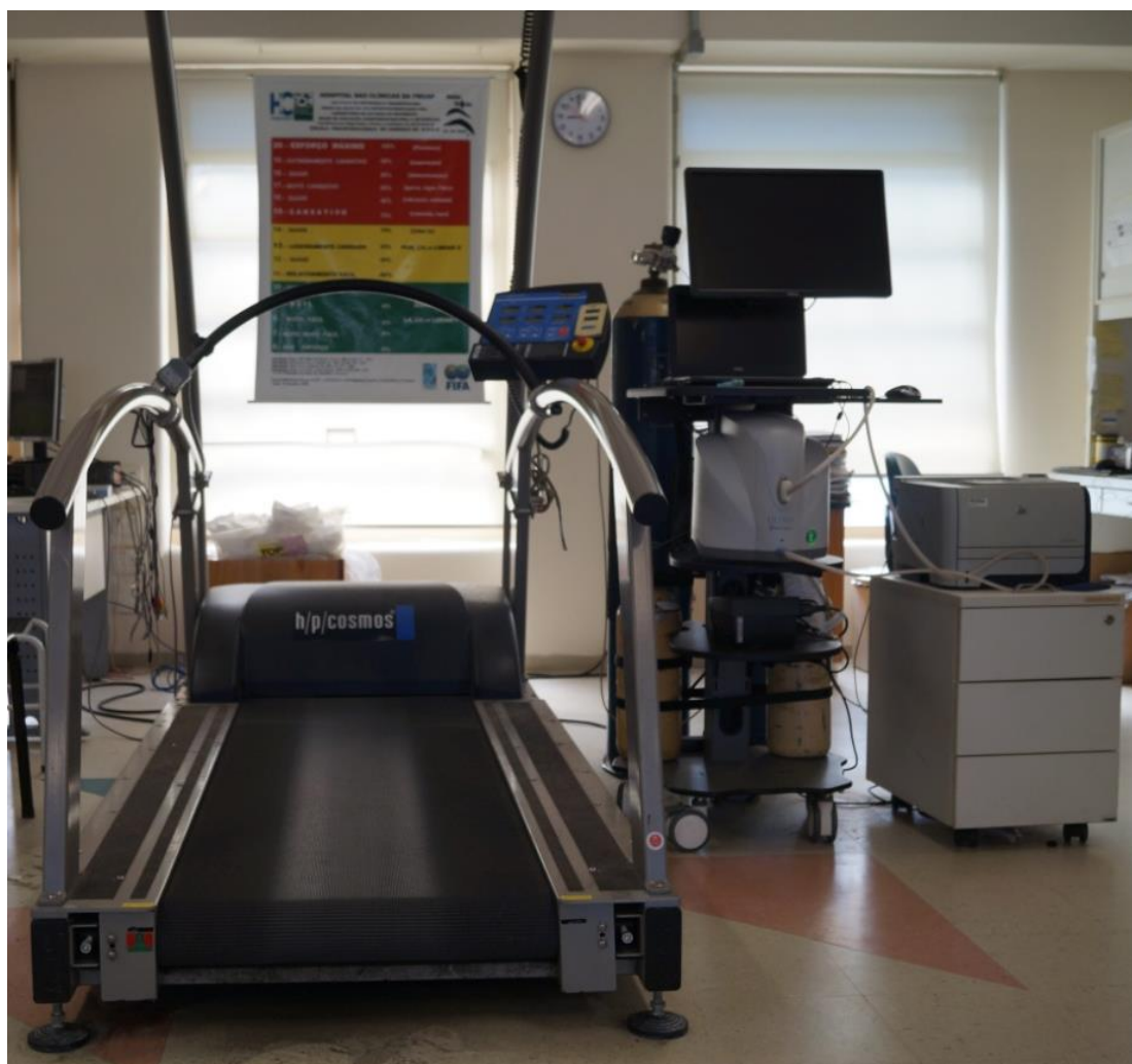
Figura 5 – Fotografia da esteira h/p/cosmos® utilizada para os testes e equipamento de análise de troca gasosa. Obtida no Laboratório de Estudos do Movimento, IOTHCFMUSP
