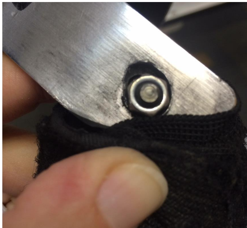
Figura 11 – Desgaste da haste de metal pela utilização da órtese e de metal pela utilização da órtese Fonte: arquivo pessoal da autora
